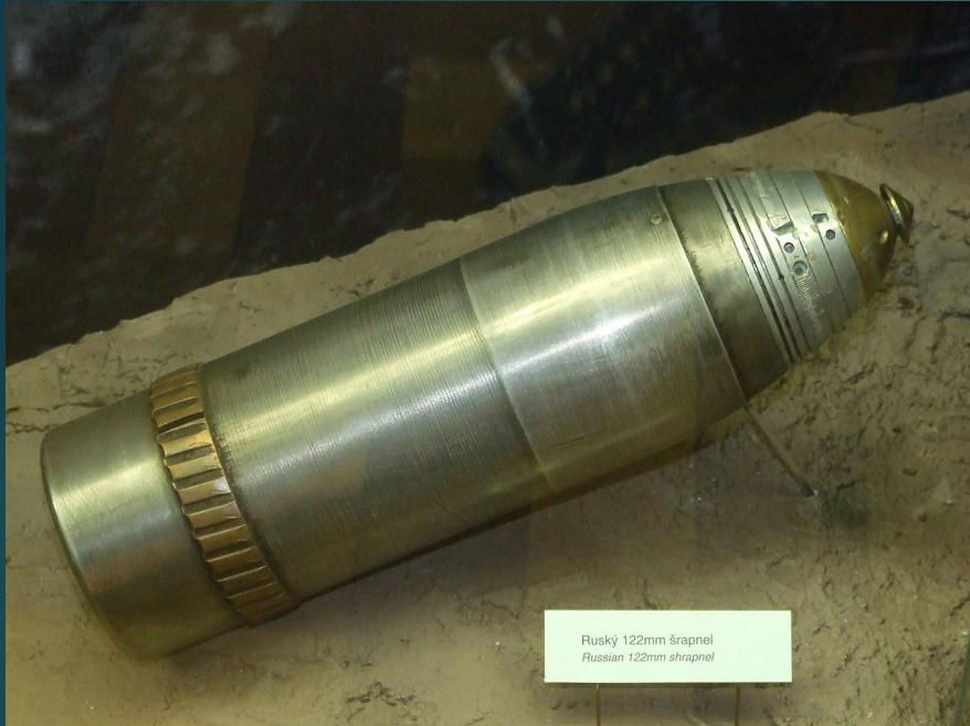
Шрапнель - арт. снаряд с готовыми поражающими элементами (сферич. пулями, стержнями и т.п.), выбрасываемыми из него вышибным или разрывным зарядом.
